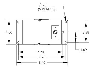
CSA/UL ENCLOSURE TYPE 2, 4, & 13 IEC ENCLOSURE IP-56 APPROXIMATE WEIGHT: 5 LBS
